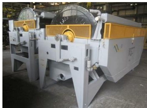
Рисунок 1. Схема (а) и общий вид (б) двухбарабанного сепаратора ПБМ-150/300 М13
